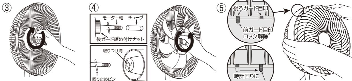
モーター軸のチューブを外し、羽根の溝とモーター軸の回り止めピンが合うようにして羽根を差し込みます。スピンナーを反時計回りにゆるまないようにしっかりと締め付けてください。
