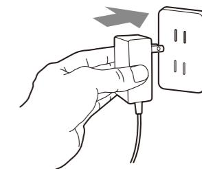
差込みプラグをコンセントに差し込んだ際に、「ピッピッ」と電子音があり、ディスプレイ及びすべてのランプが全灯します。その後ランプが消灯し、ディスプレイに現在の室温が表示されます。
